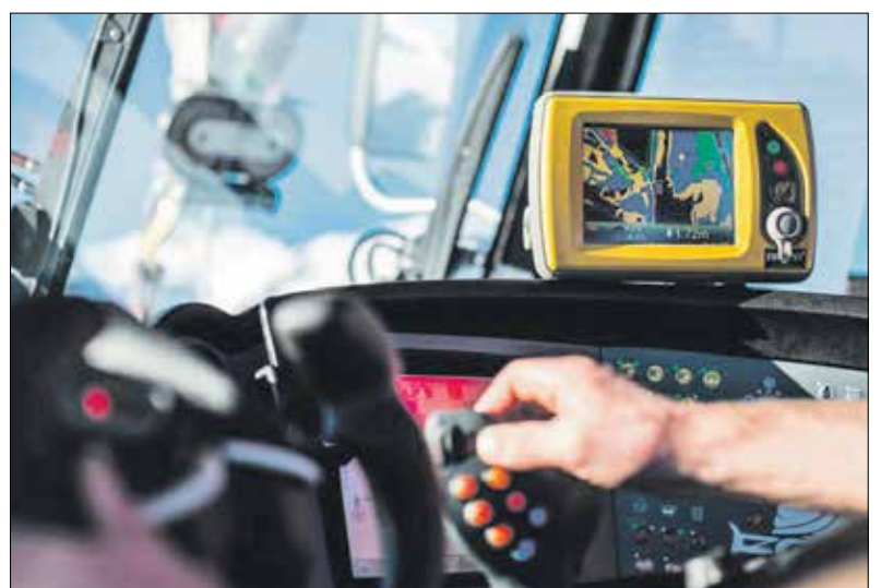
Das Pistengerät sendet via GPS seine aktuelle Höhe, diese wird mit einem digitalen Geländemodell verglichen, die Differenz entspricht der Schneehöhe. [PowerGIS]
